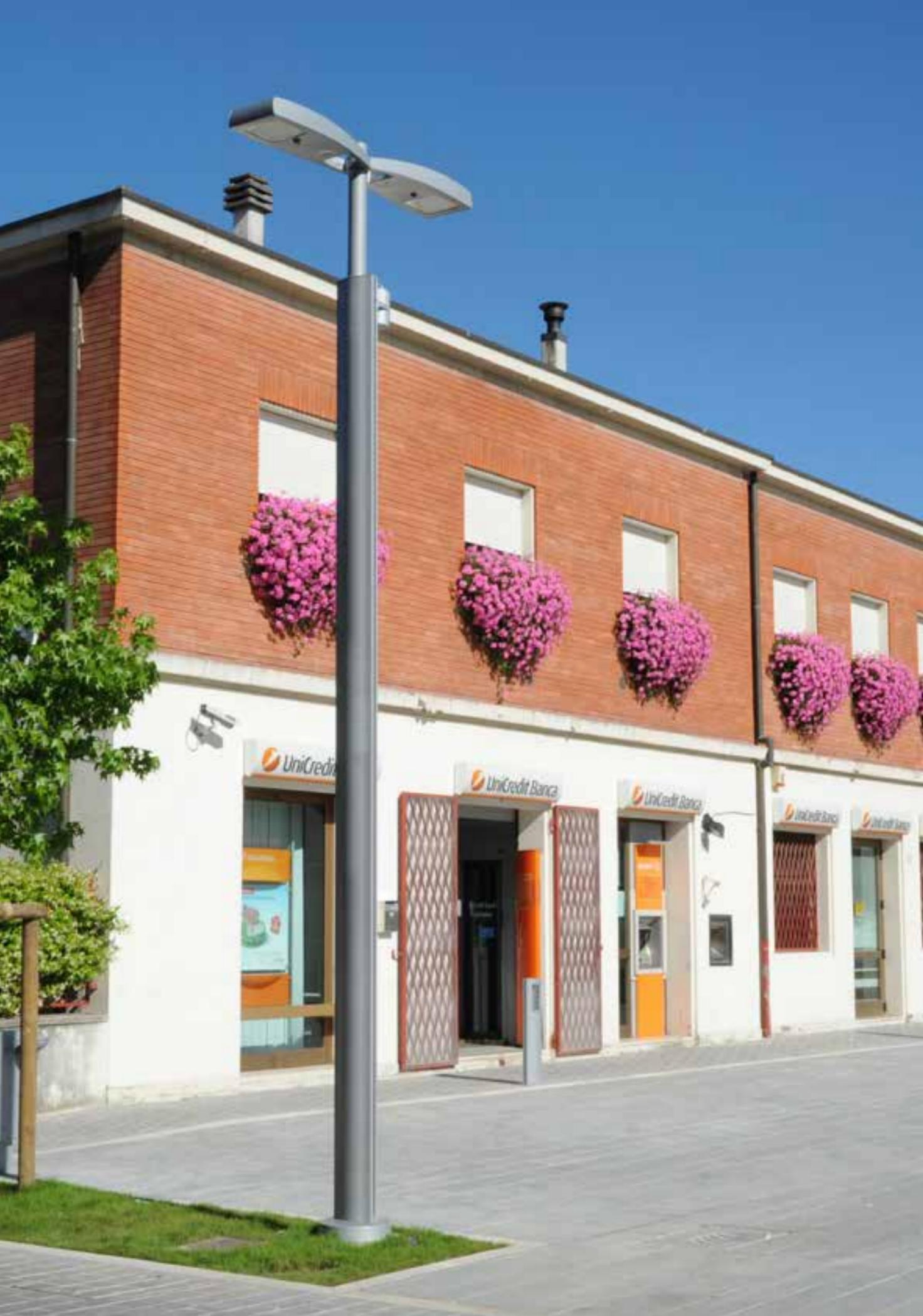
Il progetto per la città di Gambettola è un esempio di prodotto custom realizzato su richiesta dello Studio 2P Architettura di Lucca. Per ragioni illuminotecniche, i pali estrusi sono stati elevati ed integrati con Light Electra, corpo illuminante dell'omonimo sistema. I pali sono stati inoltre dotati di casse di amplificazione per le comunicazioni durante le periodiche manifestazioni della città.
